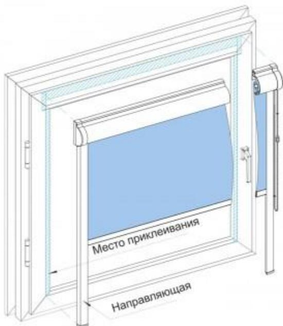
*Если на вашем окне штапик выступает относительно плоскости рамы, замер нужно производить таким образом, чтобы направляющая шириной 24 мм поместилась между выступающим штапиком и ручкой или петлями на окне. В этом случае рекомендуем вызвать замерщика, если есть такая возможность.*
